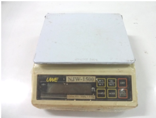
ภาพที่ 6.1 เครื่องชั่งดิจิตอลไฟฟ้าแบบ 2 ตำแหน่ง ที่มา : ผู้เขียน
