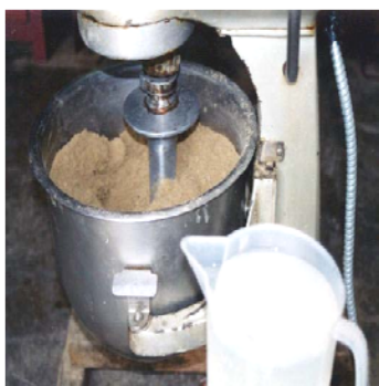
ภาพที่ 6.16 การผสมวัตถุดิบอาหารด้วย เครื่องผสมอาหารขนาดเล็ก ที่มา : อมรรัตน์และคณะ (2549)
