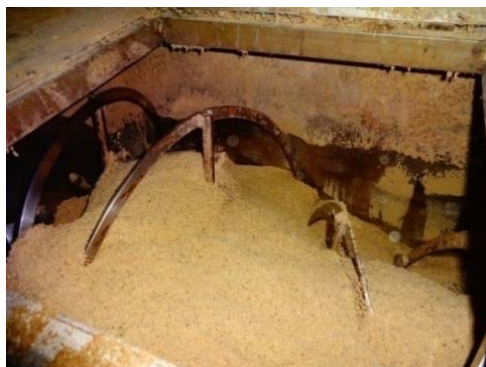
ภาพที่ 6.15 การผสมวัตถุดิบอาหารด้วย เครื่องผสมแบบแนวนอน ที่มา : ผู้เขียน
