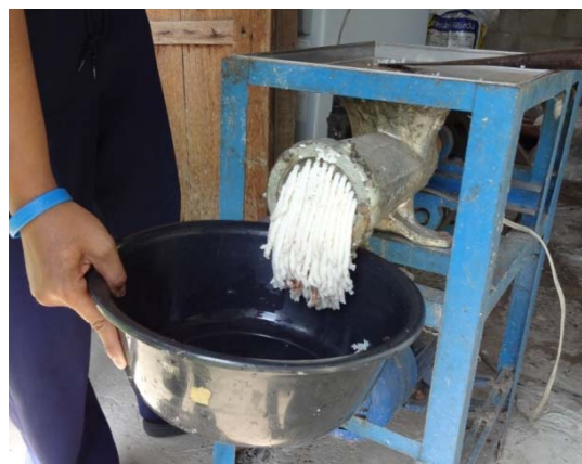
ภาพที่ 6.13 การบดปลาข้าวสุกด้วยเครื่องบดเนื้อ ที่มา : ผู้เขียน
